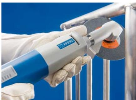
Maletín que incluye lijadora eléctrica de soldadura en ángulo y herramientas PFERD para cepillado, rectificado, limpieza y afinado de cordones de soldadura en ángulo y zonas de muy difícil acceso en componentes de acero fino (INOX).
