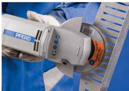
Los discos compactos de amolar POLINOX® se utilizan en amoladoras angulares de regulación electrónica para rectificado frontal. El vellón comprimido está montado sobre soporte de fibra de vidrio. Son especialmente adecuados para mecanizado de grandes superficies de acero fino (INOX).
